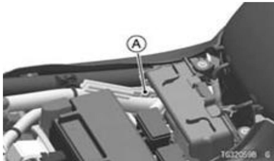
А. Разъем для подключения электрических потребителей (обогрев рукояток)
