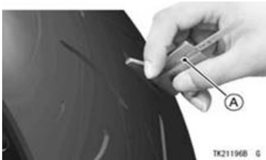
А. Измерение глубины протектора щупом
