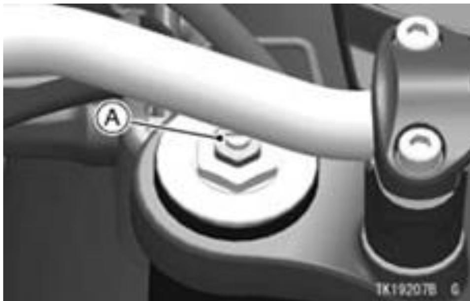
А. Регулятор предварительного натяжения пружины
